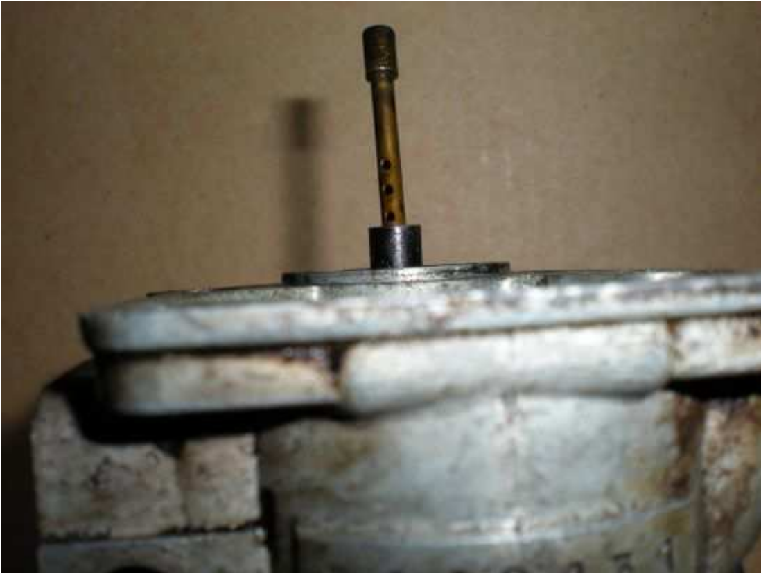
l'ajutage d'automaticité et le tube d'émulsion
