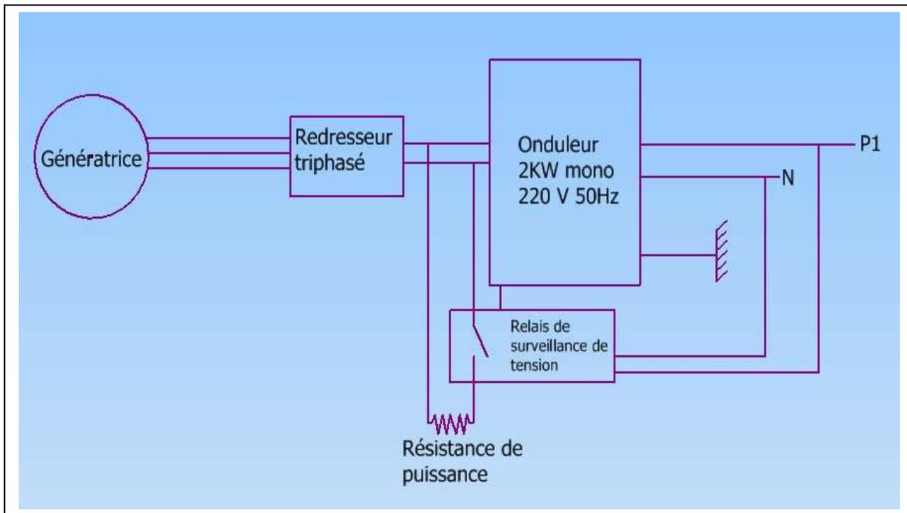
Tous les éléments (redresseur, onduleur, résistance) sont à cheiller sur mur (généralement dans un local technique, ou est déjà présent le tableau électrique). Le relais de surveillance tension ainsi qu'un disjoncteur générale sont à mettre sur le rail din du tableau électrique du local technique et à câbler suivant les plans fournis.
