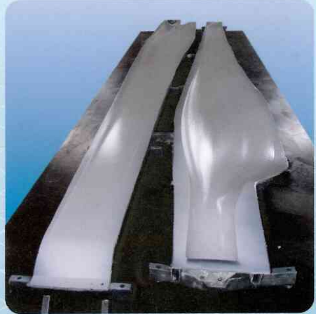
2 Dépose de la couche de gelcoat
