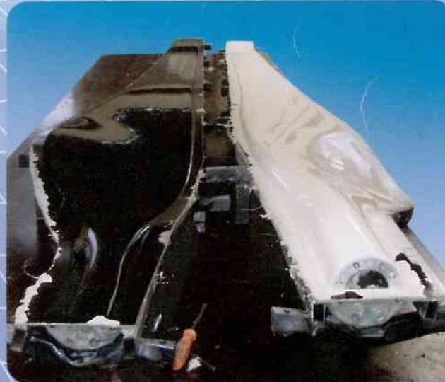
4 Temps de cycle de cuisson à 70°C, puis démoulage des éléments
