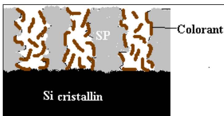
Figure III-1: Schéma représentatif de la couche poreuse imprégnée dans une solution de colorant.
