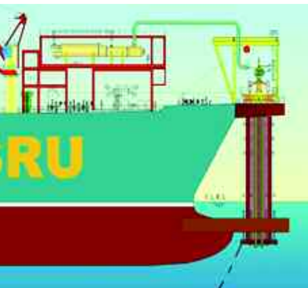
In basso: Particolare della torretta a prua del terminale FSRU OLT (© OLT Offshore LNG Toscana).
