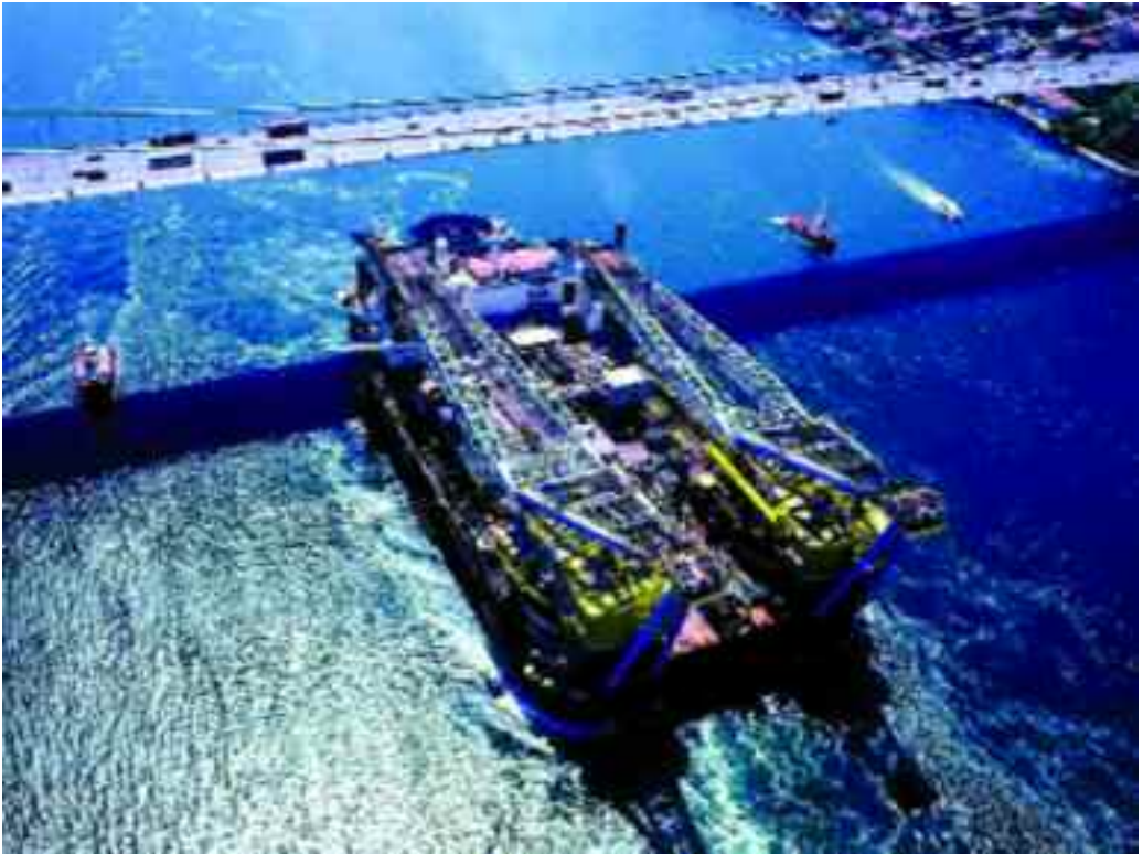
Blue Stream: il pontone semisommersibile autopropulso a posizionamento dinamico SAIPEM 7000 durante l'attraversamento del Bosforo (© Saipem).
