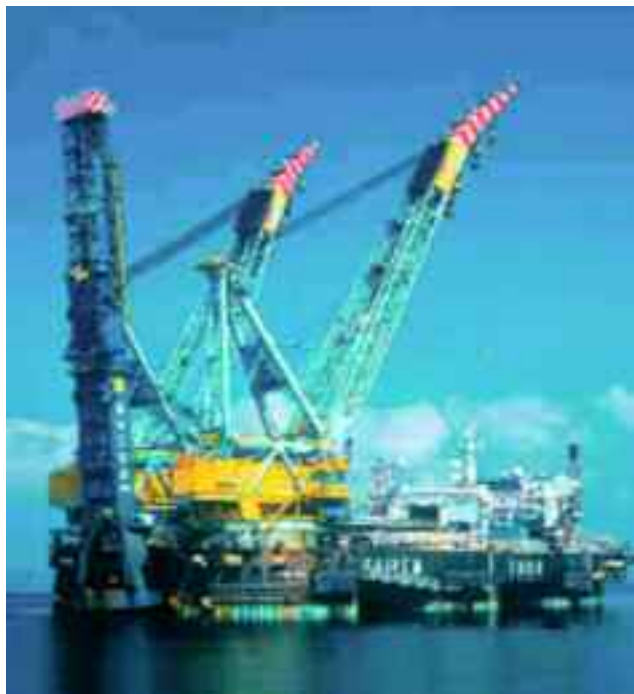
Torre per varo a J a prua del pontone semisommersibile autopropulso a posizionamento dinamico Saipem 7000, (© Saipem).
