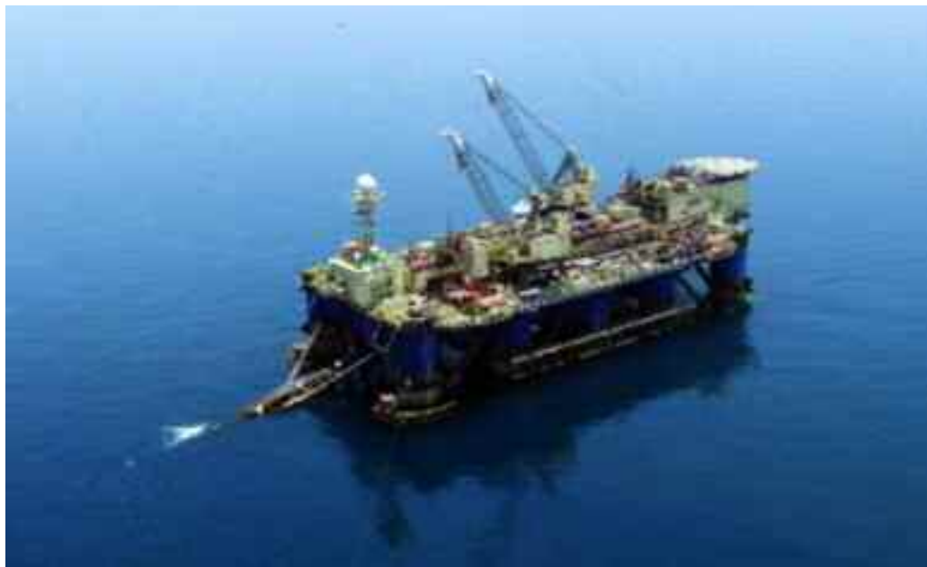
Varo a S dal pontone posatubi semisommersibile della flotta Saipem CASTORO SEI (© Nord Stream AG).
