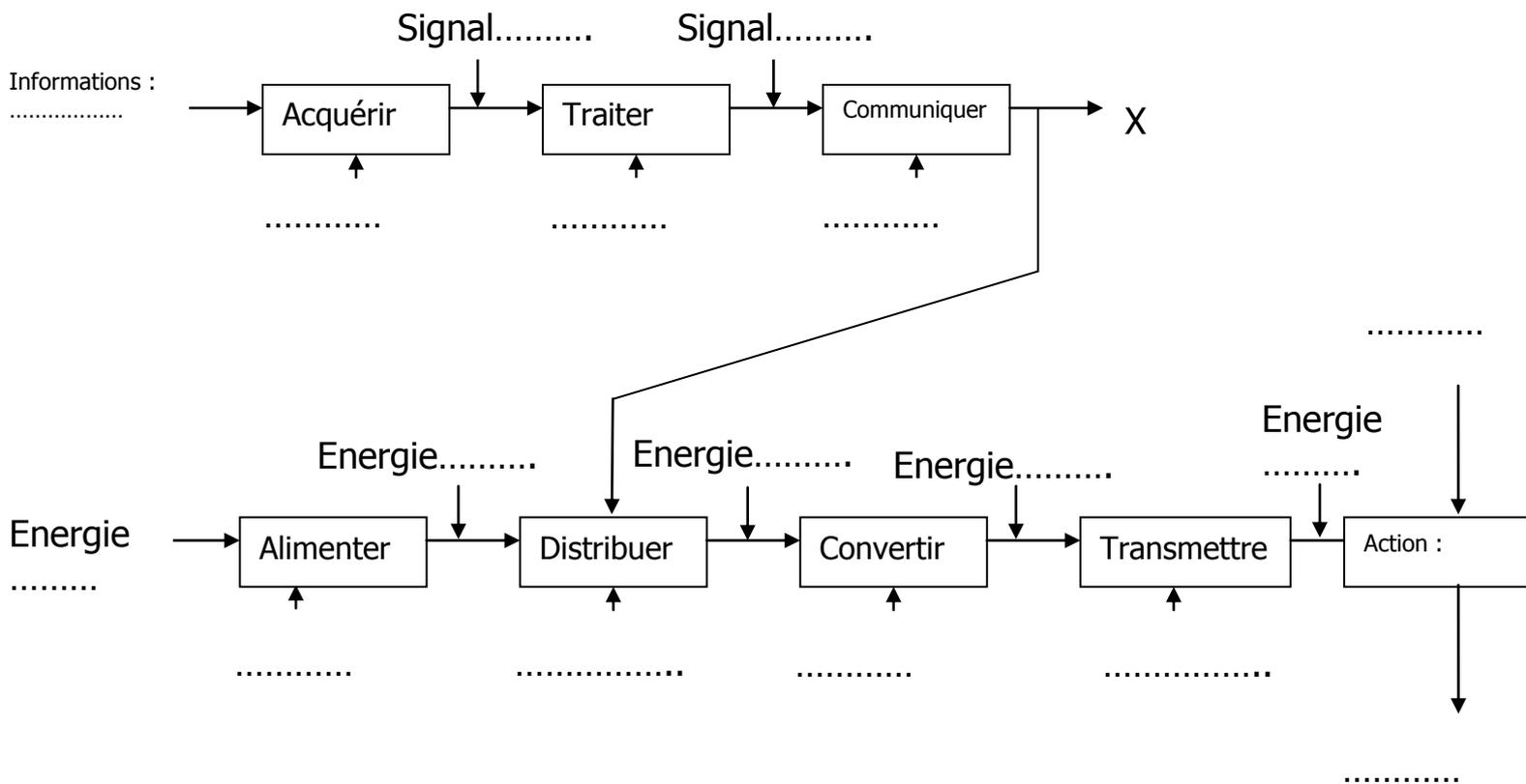
4. Chaîne de l'énergie de l'arrosage automatisé.
