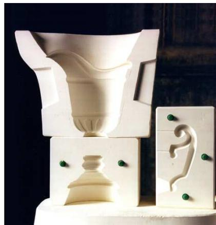
Le coulage peut être fait à l'air ou sous pression. Dans ces deux cas, le plâtre absorbe l'eau de la barbotine qui sèche progressivement. Le démoulage est facilité par le « retrait » naturel de la barbotine séchée : on obtient alors une pièce « crue ».
