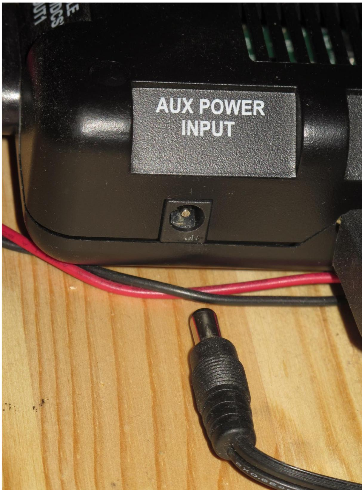
**Si vous possédez un Z-4000, vous pouvez connecter la sortie 14V de votre Z-4000 à l'entrée « AUX POWER INPUT » de votre TIU au moyen d'un adaptateur M.T.H prévu à cet effet « TIU/BARREL JACK ADAPTER CABLE », référence 50-1017. Photo ci-dessous.**
