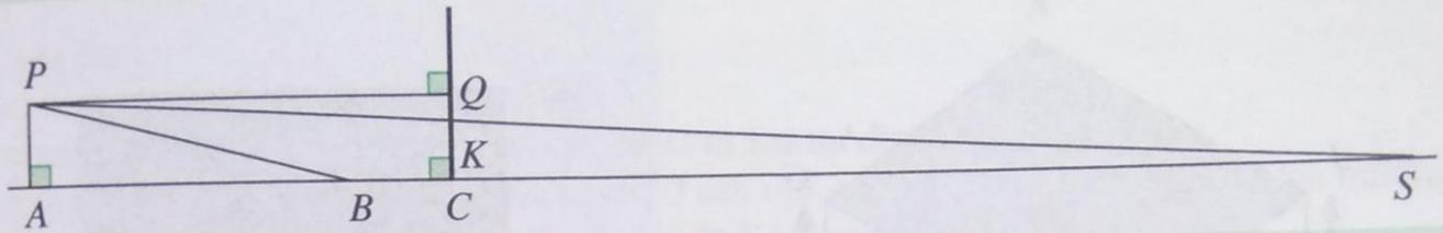
Pour que l'éclairage d'une voiture soit conforme, les constructeurs déterminent l'inclinaison du faisceau.
