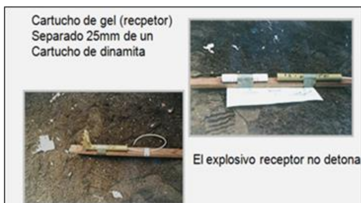
Figura 6: Ensayo al aire de un explosivo de sensibilidad reducida (gel)
