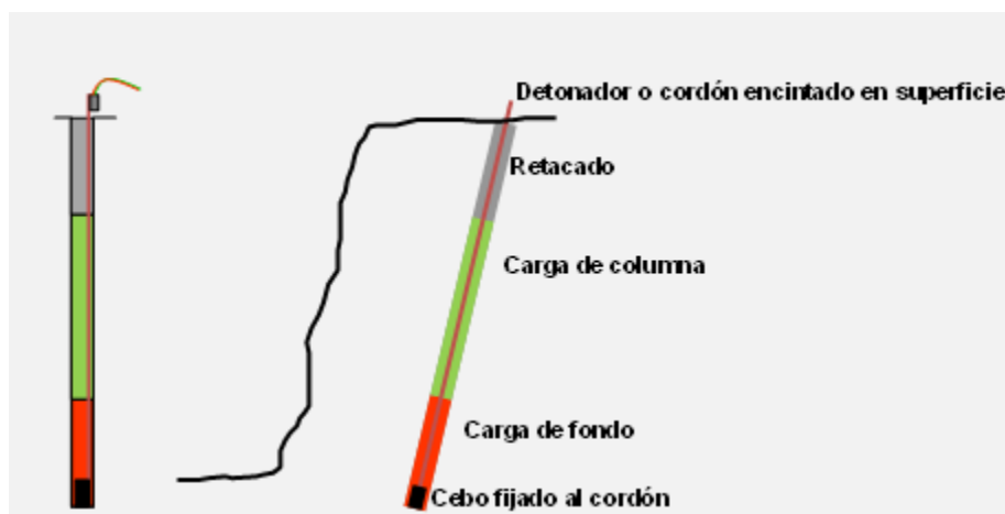
Figura 21: Esquema de iniciación en superficie
