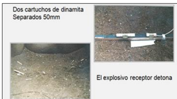
Figura 5: Ensayo al aire de un explosivo altamente sensible (dinamita)
