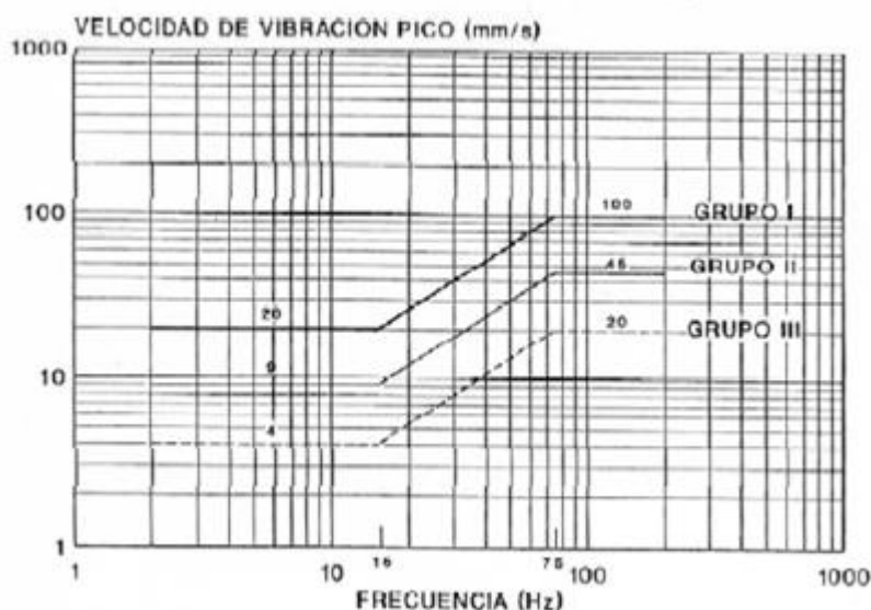
Figura 78: Velocidad de vibración norma UNE 22.381-93
