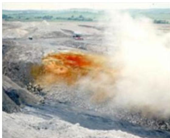
Figura 8: Humos de color naranja tras el disparo de una voladura, característicos de una detonación incompleta
