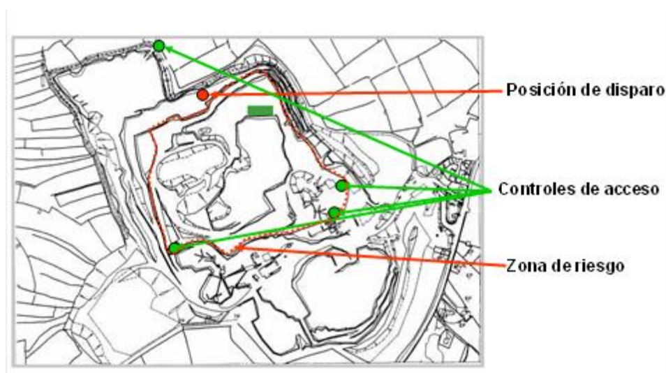
Figura 68: Plano de la explotación con los elementos principales de acceso y zona de peligro
