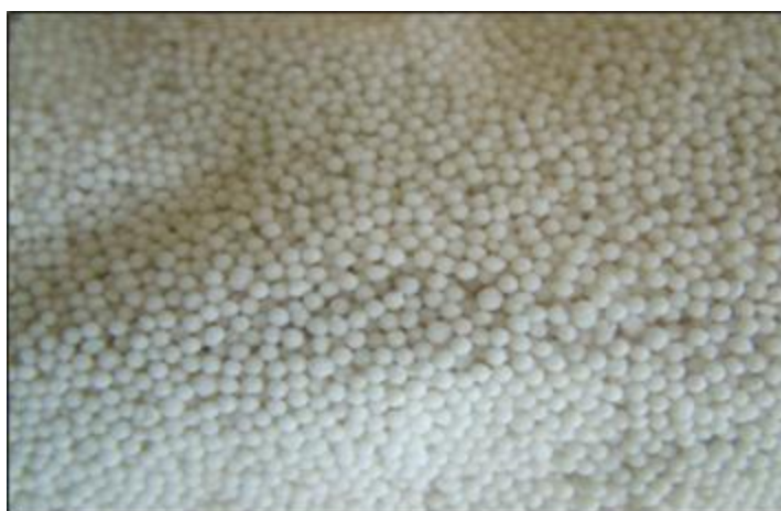
Figura 11: Aspecto de pril de nitrato amónico usado en la fabricación de ANFO
