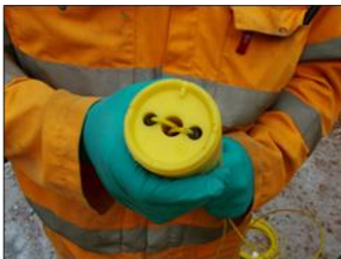
Figura 23: Preparación de un booster de cebo con dos detonadores
