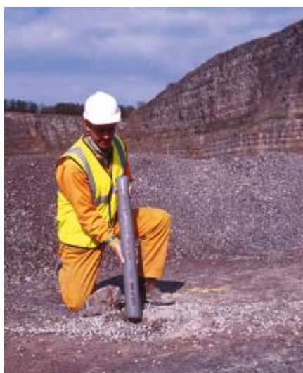
Figura 10: Carga de un cartucho de gel en un barreno
