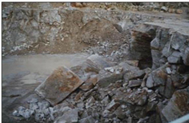
Figura 34: Condiciones geotécnicas muy complejas que impiden una fragmentación regular
