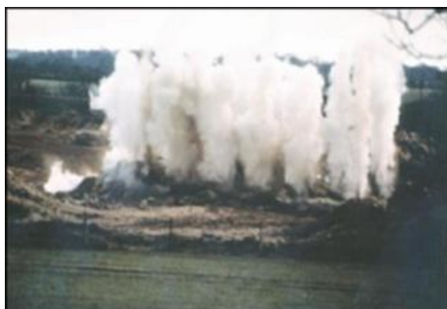
Figura 22: Barrenos iniciados en superficie. Se aprecia el efecto negativo de la rotura del retacado
