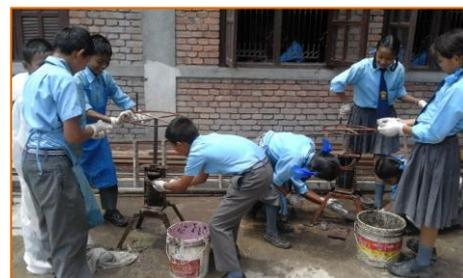
Fabrication des briquettes de papier recyclé
