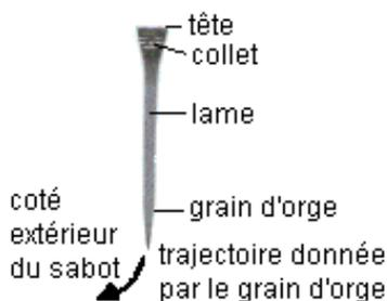
Ensuite, la lame de longueur adaptée à la taille du pied est prolongée par le grain d'orge. Le grain d'orge est un renflement qui fait dévier le clou vers l'extérieur du pied. La partie oblique du grain d'orge est appelée affilure, elle doit être placée vers l'intérieur du pied. En rando, on reprend les mêmes trous pour remettre les clous. Une fois le clou planté, on dégorge à l'aide de la râpe si besoin, puis son extrémité extérieure est recourbée, coupée et rabattue formant ainsi le rivet.
