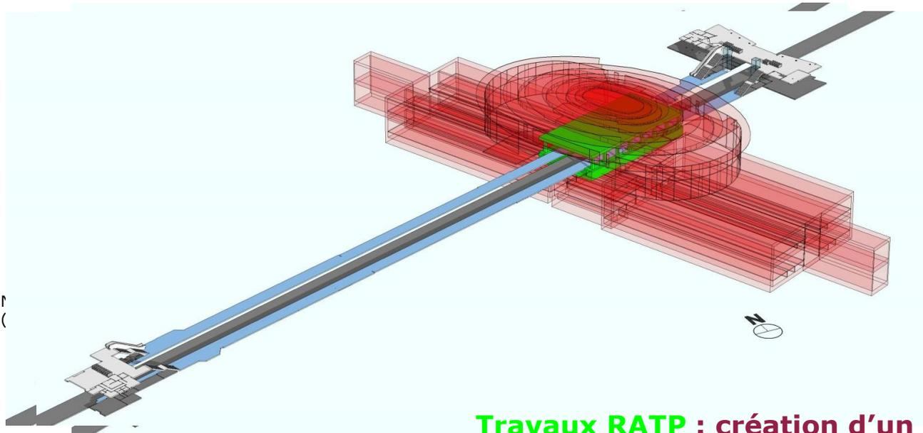
**Travaux RATP** : création d'un ouvrage cadre de support et de couverture des quais du RER A
