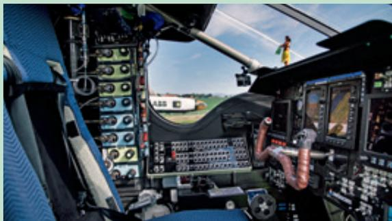
En l'absence de chauffage, le cockpit et le pilote sont protégés des -40 degrés extérieurs par une isolation thermique de haute densité.
