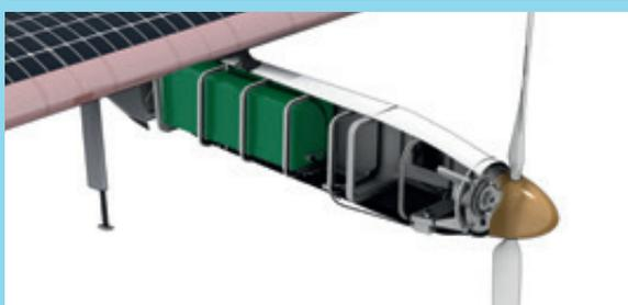
Extrados de l'aile recouvert d'une peau de cellules solaires encapsulées et intrados entoilé d'un film flexible et hautement résistant.
