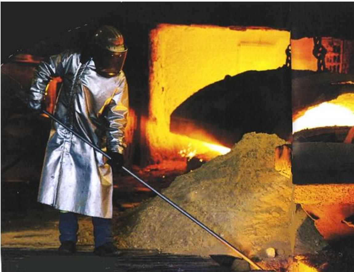
*Cokier protégé de la chaleur des fours à coke par des protections amiantées*
