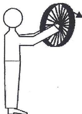
Lorsque la roue n'est pas en rotation le manipulateur n'aura aucun mal à faire pivoter la roue.
