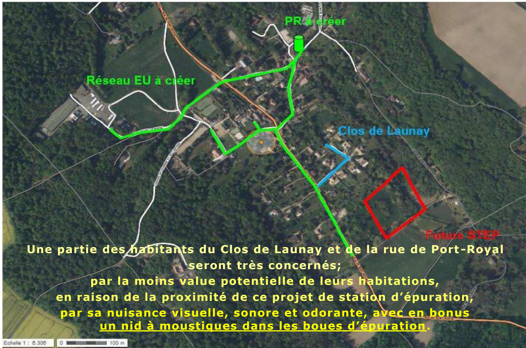
Figure 3 : Implantation envisagée pour les futurs réseaux d'eaux usées (source : IRH Ingénieur Conseil – Etudes préalables pour la définition de la faisabilité de l'unité de traitement du bourg de Saint-Lambert-des-Bois – 2014)
