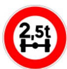
B13a Accès interdit aux véhicules pesant sur un essieu plus que le nombre indiqué
