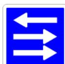
C21b Indication des voies affectées à chaque sens de circulation sur la chaussée abordée. Les voies successivement rencontrées sont figurées de bas en haut
