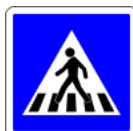
C20a Passage pour piétons sur chaussée
