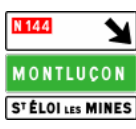
D31e Panneau de signalisation avancée de sortie non numérotée
