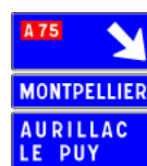
D31f Panneau de signalisation avancée de bifurcation autoroutière
