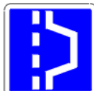
C8 Indication d'un emplacement d'arrêt d'urgence. L'emplacement constitué par un aménagement ponctuel de l'accotement est strictement réservé aux arrêts d'urgence
