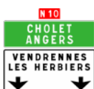
Da31b Panneau de signalisation avancée d'affectation de voies de sortie non numérotée
