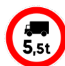
S11b Direction interdite ou déconseillée aux véhicules de transport de marchandises dont le poids total autorisé en charge ou le poids total roulant autorisé excède le nombre indiqué
