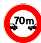
B17 Interdiction aux véhicules de circuler sans maintenir entre eux un intervalle au moins égal au nombre indiqué
