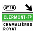
D31d Panneau de signalisation avancée de sortie numérotée
