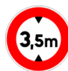
B12 Accès interdit aux véhicules dont la hauteur, chargement compris, est supérieure au nombre indiqué
