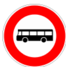
B9f Accès interdit aux véhicules de transport en commun de personnes
