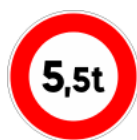
B13 Accès interdit aux véhicules, véhicules articulés, trains doubles ou ensemble de véhicules dont le poids total autorisé en charge ou le poids total roulant autorisé excède le nombre indiqué
