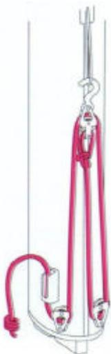
1. Accrocher avec la manille le point d'amure du foc à la cadène en s'assurant que le manillon soit placé vers l'arrière du bateau. (si le manillon est orienté vers l'avant, le spi pourrait s'y accrocher)
