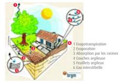
Un sol argileux change de volume selon son humidité comme le fait une éponge ; il gonfle avec l'humidité et se resserre avec la sécheresse, entraînant des tassements verticaux et horizontalement, des fissurations du sol.
