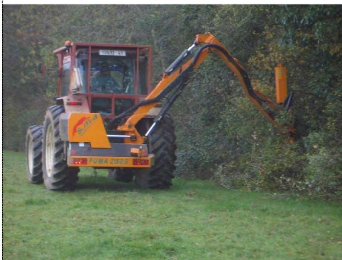
*Parfois une barre de coupe latérale est montée sur une faucheuse. L'usage de l'**épareuse** (broyeur monté sur un bras articulé) est encore très fréquent mais abîme les arbres en les déchiquetant. Si les branches sont souples, cela oblige à appuyer l'outil contre la haie et à en rogner l'épaisseur. Les marteaux s'émousent rapidement et éclatent le bois. Les débris de la haie n'ont pas besoin d'être ramassés, mais la biomasse s'accumule au fond du fossé.*
