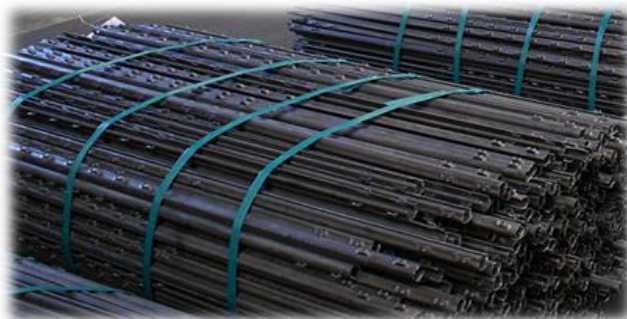
Ici un paquet de piquets profilés en acier brut pas encore galvanisé à chaud au trempé.
