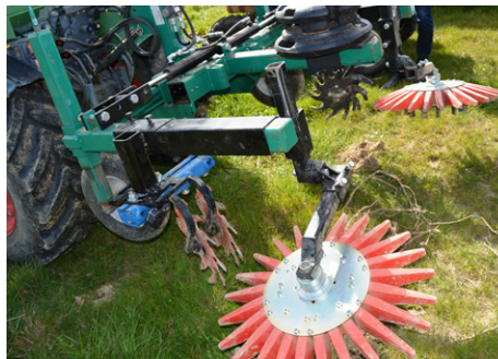
Photo 2 : les outils interceps de type passif qui favorisent une vitesse de travail élevée (jusqu'à 7 km/h) sont les plus économes en carburant
