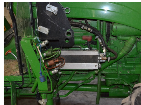
Photo 1 : Détail du débitmètre de marque AIC utilisé pour les mesures
