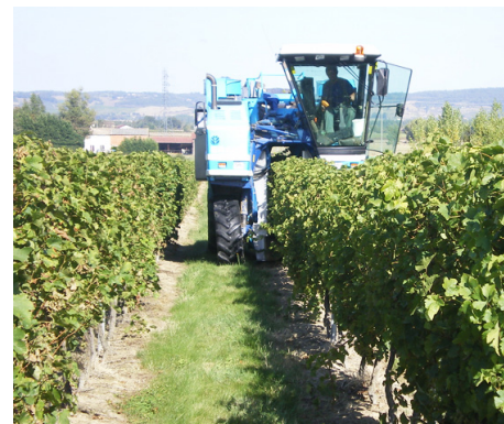
Photo 3 : Les machines à vendanger qui sont maintenant dotées de systèmes de régulation du régime moteur font partie des matériels viticoles oubliés dans notre étude
