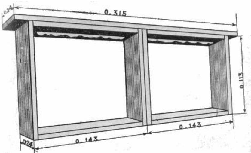
Pour remplacer les sections américaines, fixer deux cadres 0,143 x 0,113 à un porte-rayon. Placer huit porte-rayons ainsi garnis dans une hausse d'une hauteur de 0,13 au lieu de 0,21.
