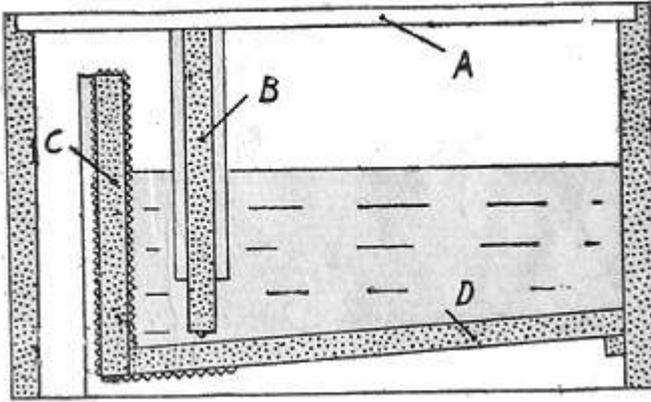
B. - Planche mobile entre tasseaux reposant sur le fond par deux pointes à tête ronde de 0,002 permettant le passage du liquide et non des abeilles. Cette planche est enlevée quand on donne des débris de rayons au lieu de sirop.
