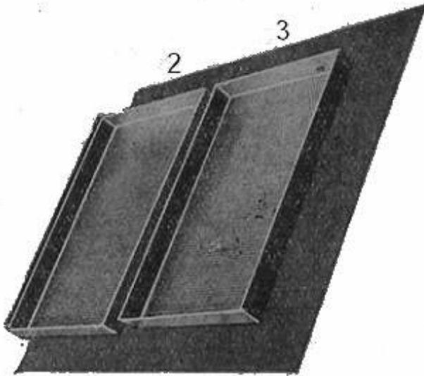
Cage 2. Tôle perforée, force 5/10, dimensions 0,275 x 0,380. Trous de 3 mm, à 3 mm les uns des autres ; les bords sur une largeur de 20 mm sont repliés après la coupe des coins. Il n'y a pas de soudure
