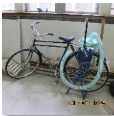
C'est ainsi que Ken Abwao, mon guide au profil ascétique et sandales de savane, va me sortir une bicyclette toute simple mais dotée d'un bidon en plastique et d'un grand tuyau bleu. On conduit la bécane au bord de la fosse septique. On la met sur une base permettant de soulever la roue arrière. Il suffit alors de l'enfourcher et de pédaler pour que le contenu arrive directement dans le bidon, que l'on peut décharger dans un endroit spécial, sans rien toucher de malsain.
