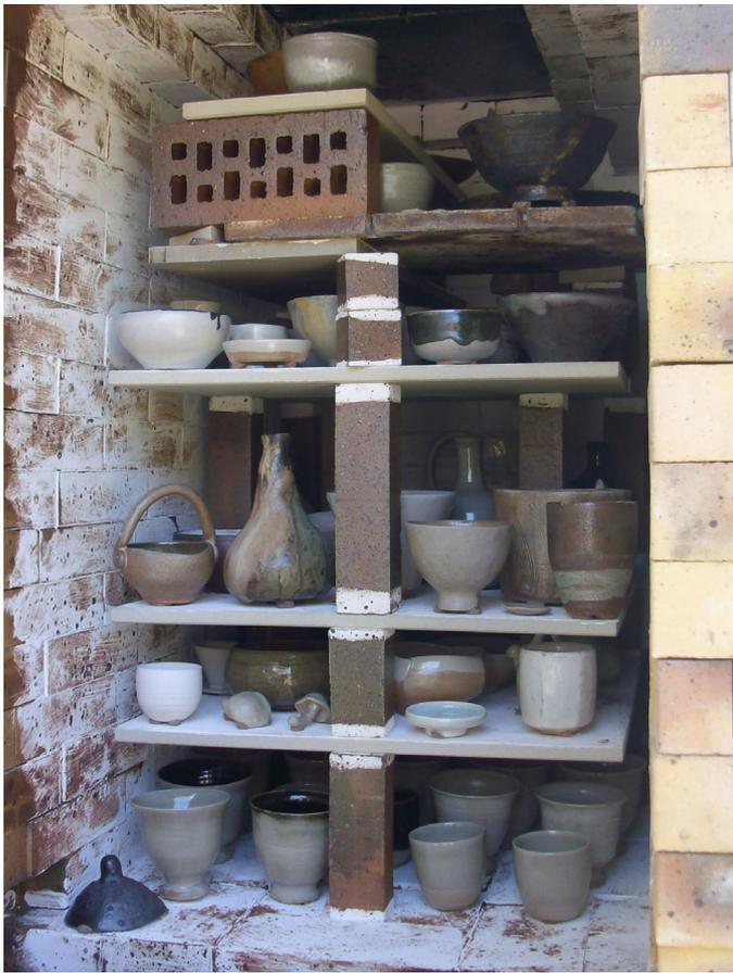
1 - Préparer les plaques et les piliers (engobe).
