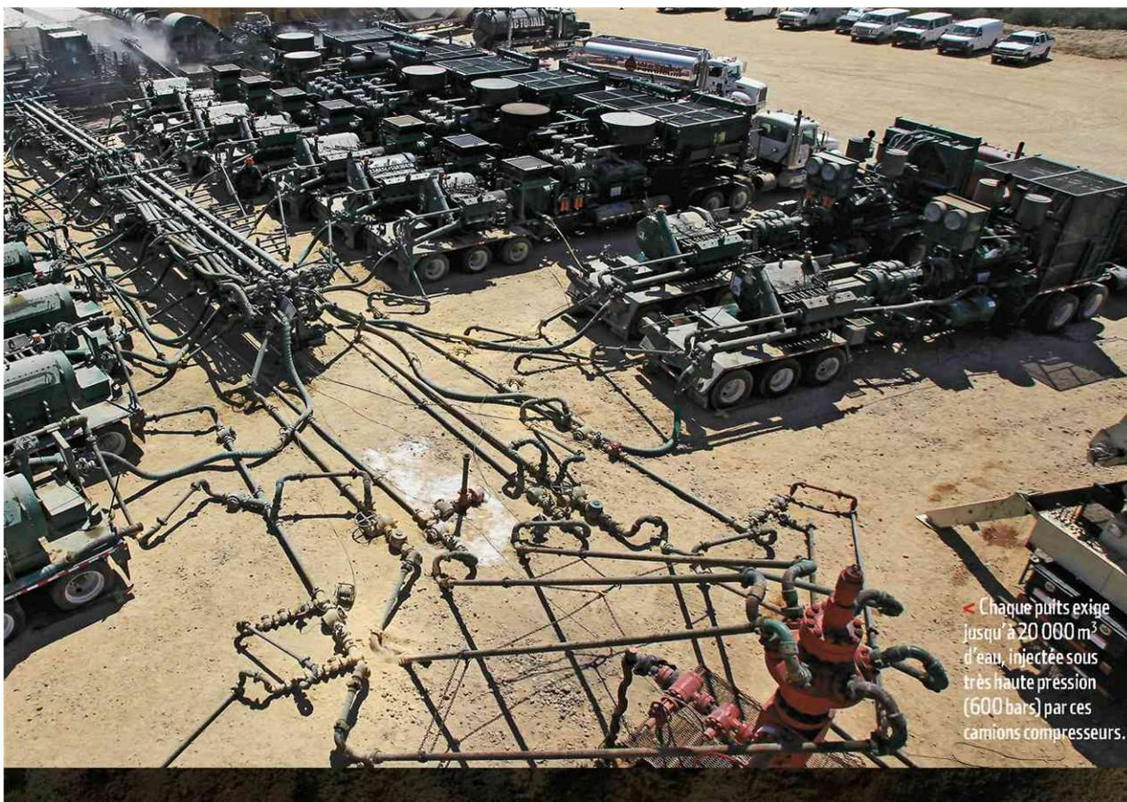
Chaque puits exige jusqu'à 20 000 m<sup>3</sup> d'eau, injectée sous très haute pression (600 bars) par ces camions compresseurs.
