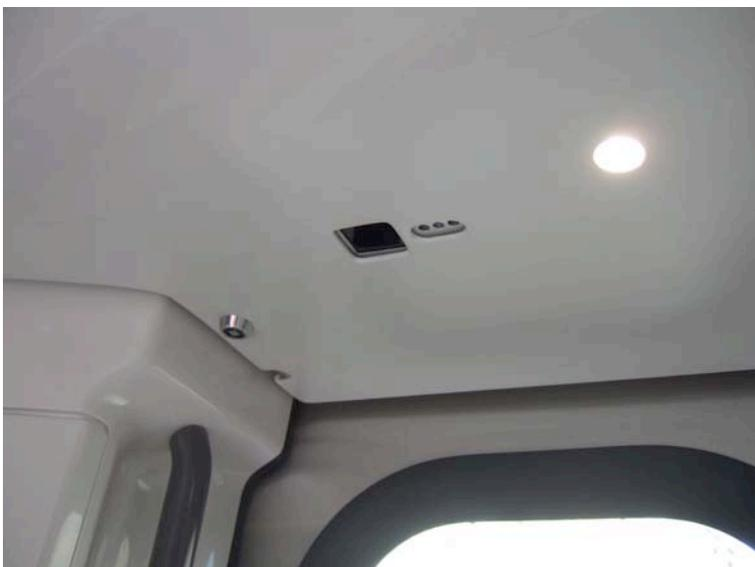
Il existe au dessus de chaque porte d'entrée un système de comptage automatique des voyageurs, à base de mini-caméras, au nombre de 3 par porte.
