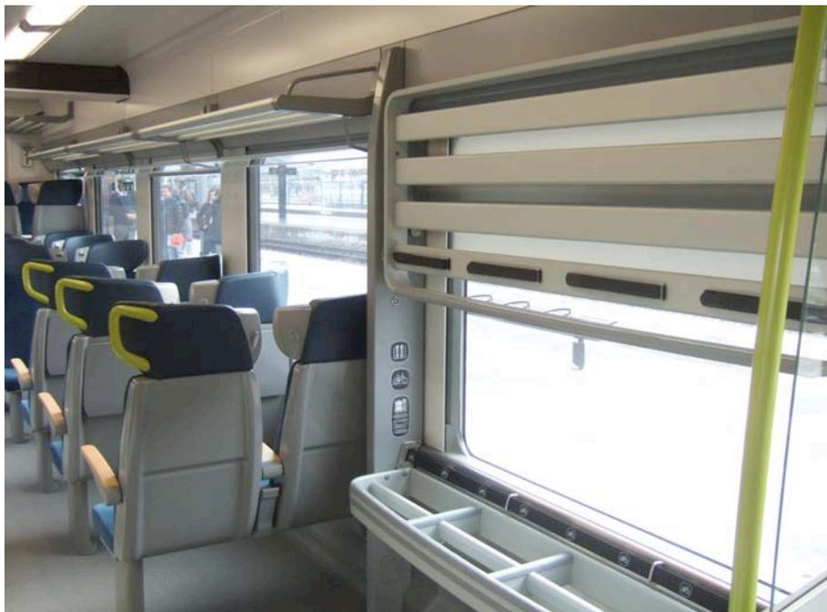
Le porte bagages repliable, et en partie basse, la zone pour ranger un ou deux vélos longitudinalement.
