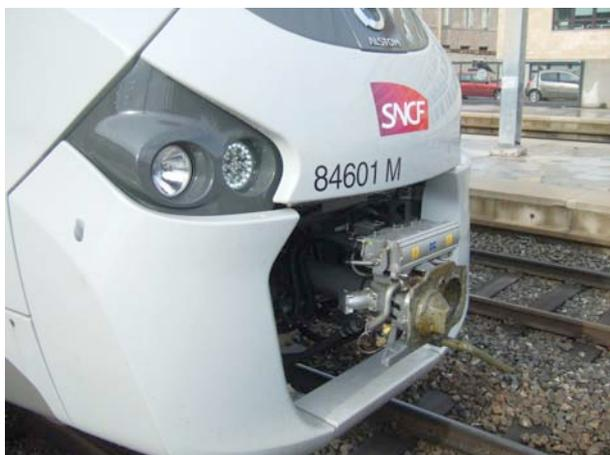
Encore un ensemble de très haute technologie : l'attelage automatique chocs et traction Scharfenberg, qui assure également les connexions électriques pour la marche en Unités Multiples.
