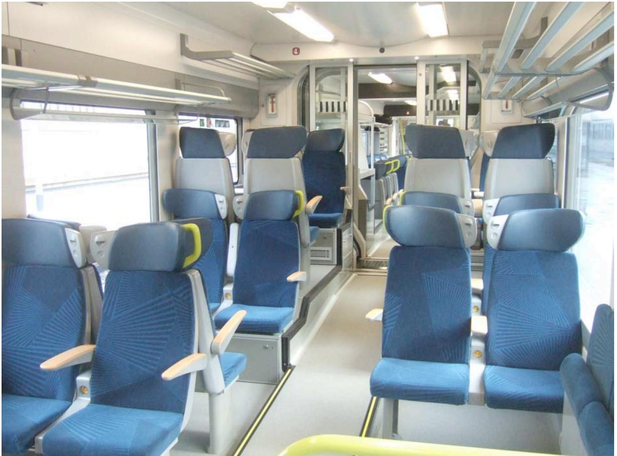
Sur la photo ci-dessus, on peut remarquer les sièges surélevés, situés au dessus du bogie porteur commun à deux caisses.
