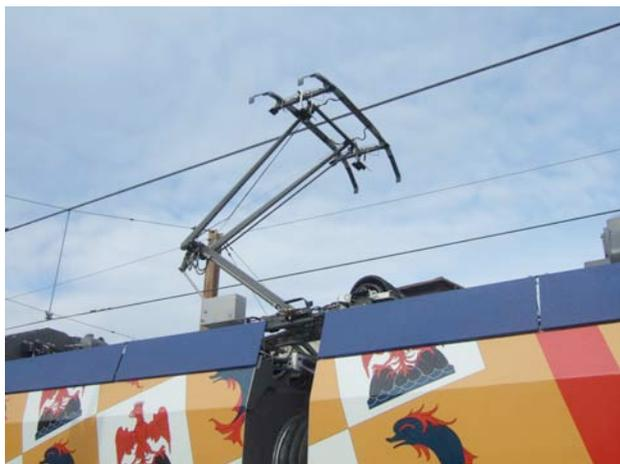
Il y en a deux, montés sur le toit de la même remorque, un pour le 1500 V (palette de 1950 mm), un autre pour le 25 kV (palette de 1450 mm)
