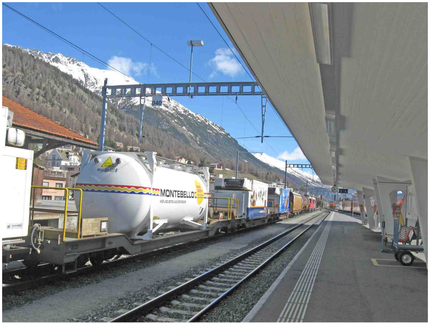
Double traction de Ge 4/4 II série 611 à 633 - construction 1986 - 1992 vitesse limite: 80 km/h - puissance 1180 KW (1600 CV) soit 2360 KW (3200 CV) en tête de ce long train de fret arrivant à Samedan
