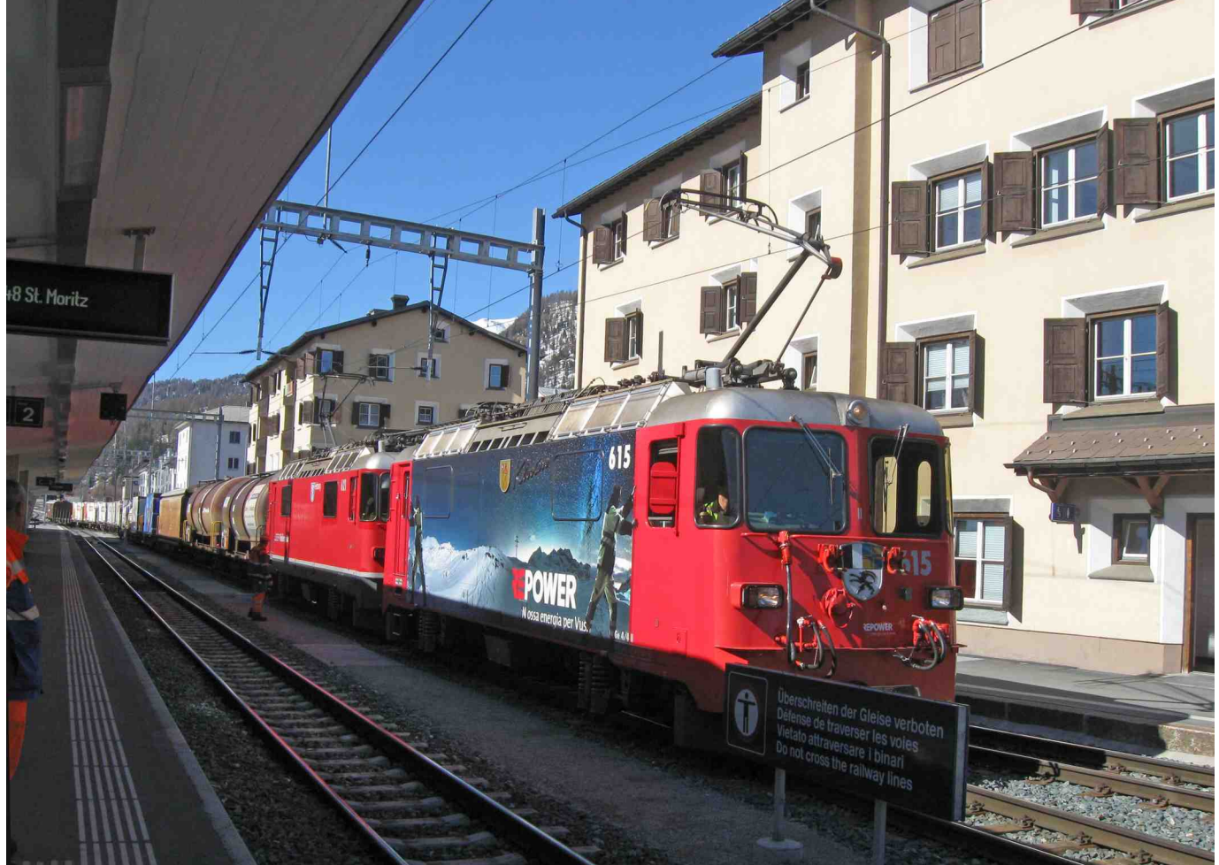
Double traction de Ge 4/4 II série 611 à 633 - construction 1986 - 1992 vitesse limite: 80 km/h - puissance 1180 KW (1600 CV) soit 2360 KW (3200 CV) en tête de ce long train de fret arrivant à Samedan
