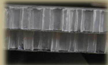
Nid d'abeilles en polypropylène Alvéoles hexagonales de 8 mm Faces revêtues d'un non tissé en polyester servant de support de stratification ou de collage Film plastique entre les alvéoles et le non tissé pour éviter le remplissage des alvéoles par la résine ou la colle. Caractéristique :
