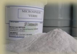
Applications : coulée de résine (sanitaire), allègement des enduits, mastics et marbre composites.
