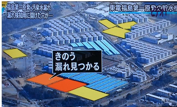
Image extraite d'une émission télé de la chaîne NHK, du 8 mars. Le réservoir coloré en orange, en bas et à gauche, s'est mis à fuir. TEPCO a déjà réalisé sept de ces réservoirs (en orange et en jaune) selon le même mode de construction, il est donc possible que les autres également se mettent à fuir.
