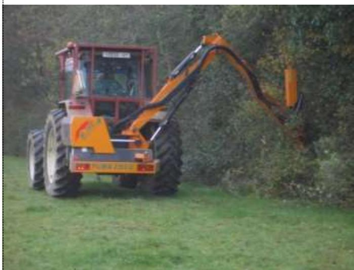
*Parfois une barre de coupe latérale est montée sur une faucheuse. L'usage de l'**épareuse** (broyeur monté sur un bras articulé) est encore très fréquent mais abîme les arbres en les déchiquetant. Si les branches sont souples, cela oblige à appuyer l'outil contre la haie et à en rogner l'épaisseur. Les marteaux s'émoussent rapidement et éclatent le bois. Les débris de la haie n'ont pas besoin d'être ramassés, mais la biomasse s'accumule au fond du fossé.*
