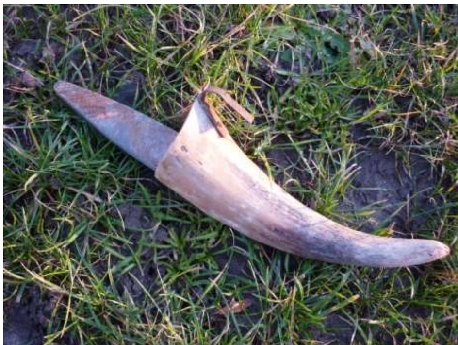
*La pierre à aiguiser est gardée humide dans un coffre, c'est-à-dire un étui rempli d'eau. Cet étui est muni d'une attache métallique permettant de l'accrocher à la ceinture. Souvent en corne de bovidé, il peut être fait aussi en tôle de fer étamé soudée à l'étain.*
