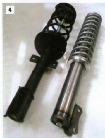
amortisseurs ont le grand avantage de s'adapter sans aucune modification sur un Duster de série. La seule différence visuelle est, sous le capot, la petite valve présente en haut de chaque amortisseur. « Il est possible de les recharger en azote si nécessaire » précise leur concepteur, « et ils sont également réglables en hauteur en fonction du poids embarqué. Nous avons également voulu qu'il soient 100 % reconditionnables ». Complétés par des ressorts Eibach,
